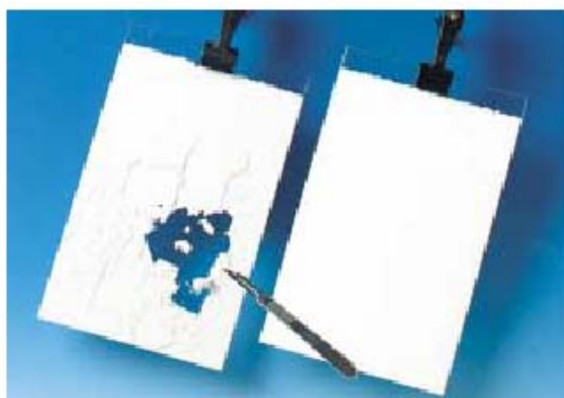
Слева: обычная дисперсионная фасадная краска Справа: Amphibolin
